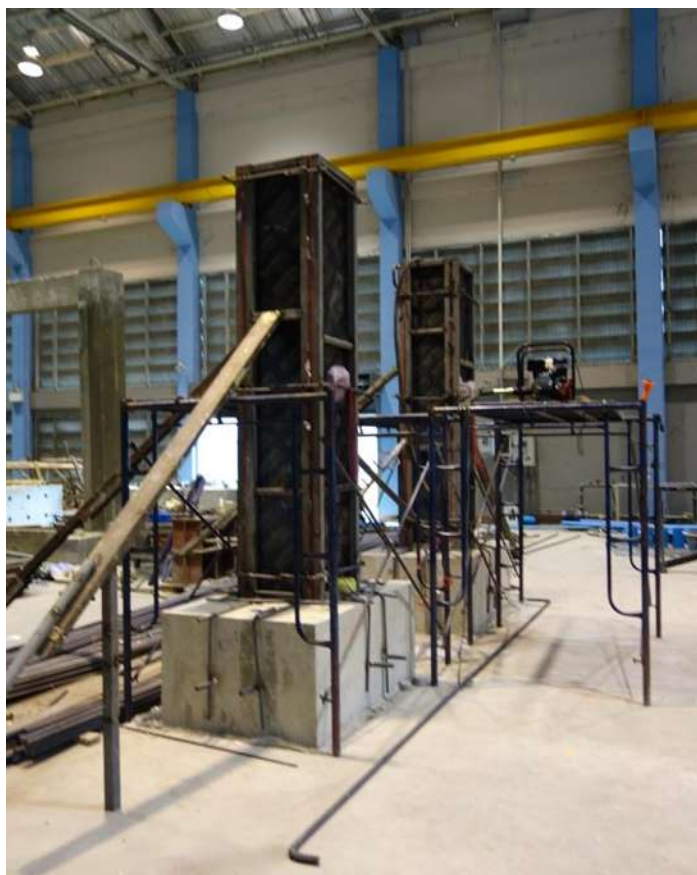
รูปที่ 4-24 ตัวอย่างทดสอบเสาสะพาน
