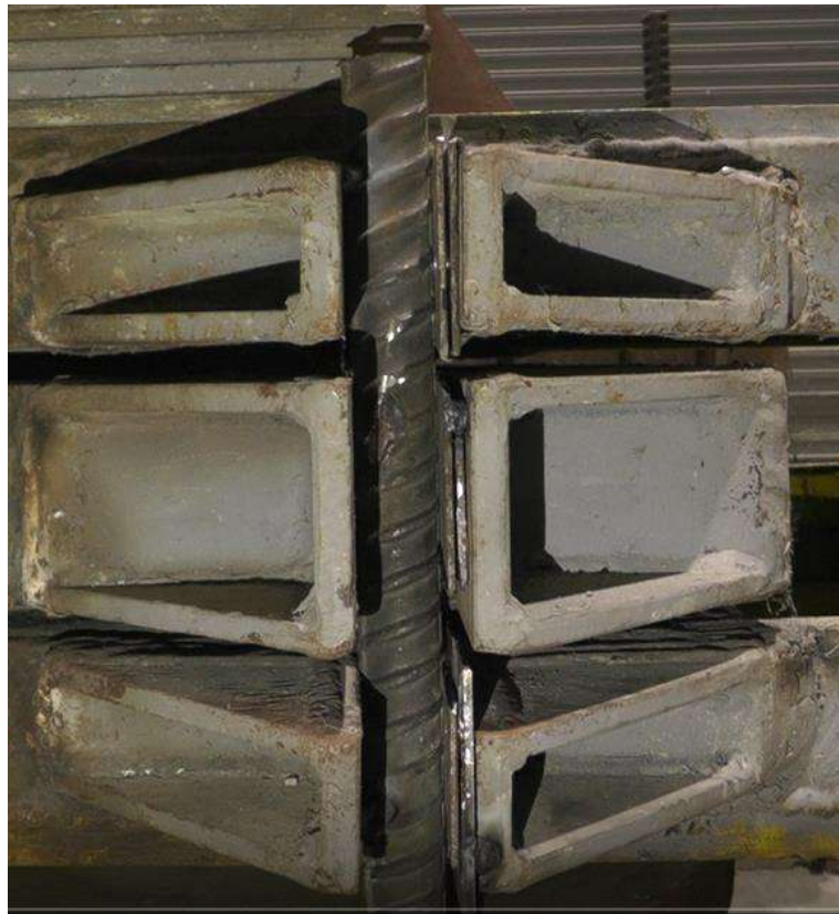
รูปที่ 4-12 เหล็กเดือยภายหลังการติดตั้งเข้ากับชุดทดสอบ
