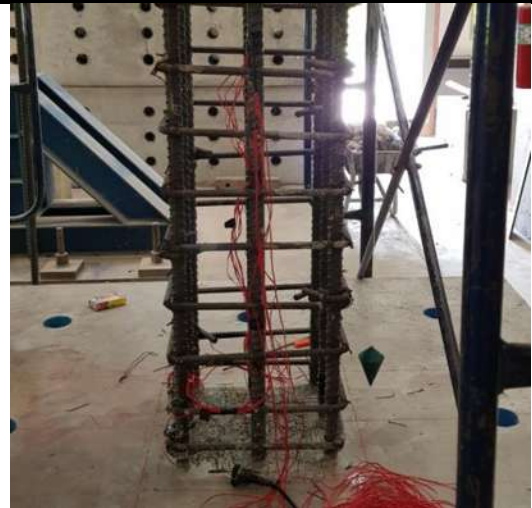
รูปที่ 4-69 การติดเกจวัดความเครียดในเหล็กเสริม
