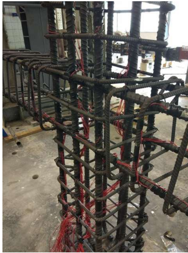
รูปที่ 4-45 การติดตั้งเกจวัดความเครียดในชิ้นงาน
