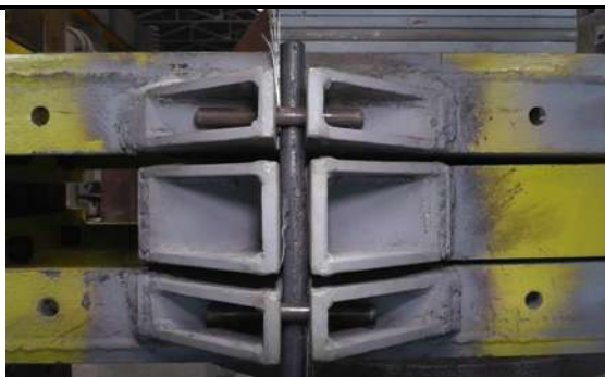
รูปที่ 2-75 ลักษณะการเสียรูปของเหล็กเดือยหลังจากสิ้นสุดการทดสอบ
