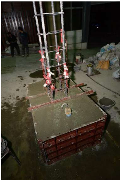
รูปที่ 2-7 ขั้นตอนตัวอย่างเสาขณะกำลังเทคอนกรีต และภายหลังการถอดไม้แบบ
