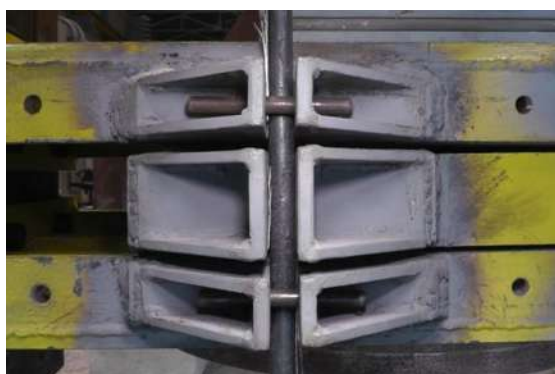
รูปที่ 2-73 ลักษณะการเสียรูปของเหล็กเดือยภายหลังจากการให้แรงกระทำที่ระดับการเคลื่อนที่ 4 มิลลิเมตร
