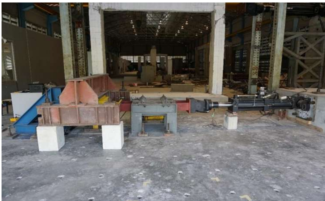
รูปที่ 4-4 ภาพรวมชุดทดสอบแผ่นยางรองสะพาน
