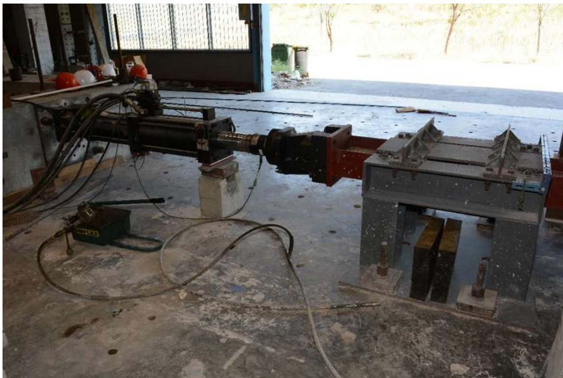
รูปที่ 2-57 ภาพรวมชุดทดสอบแผ่นยางรองสะพาน
