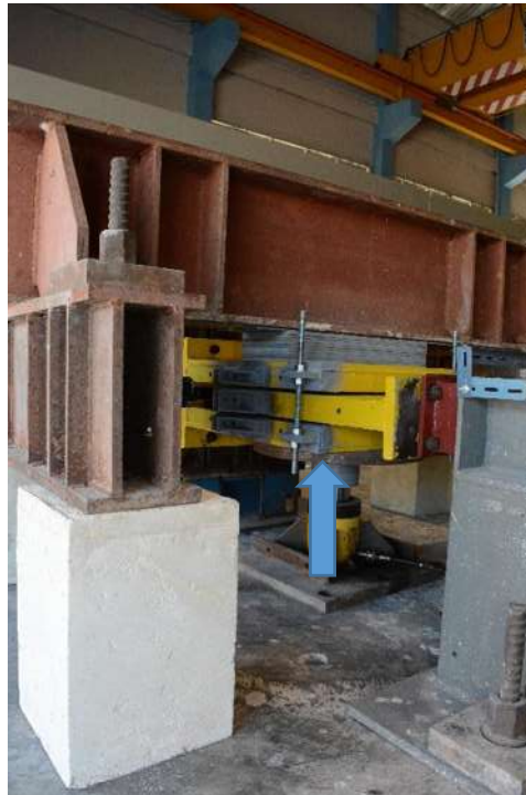
รูปที่ 2-58 การให้แรงอัดในแนวแกนด้วยแท่นไฮดรอลิก
