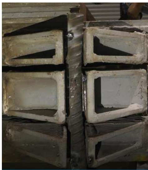
รูปที่ 4-18 ลักษณะการเสียรูปของเหล็กเดือยหลังจากสิ้นสุดการทดสอบ
