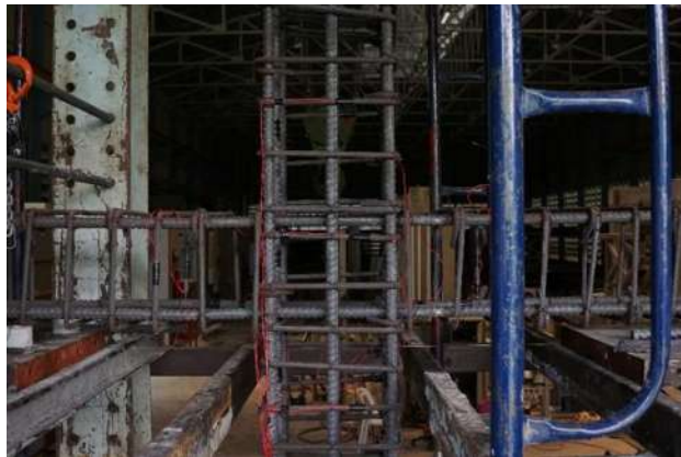
รูปที่ 4-69 การติดเกจวัดความเครียดในเหล็กเสริม
