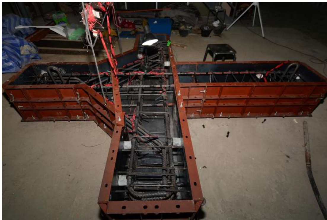
รูปที่ 2-33 การติดตั้งเกจวัดความเครียดในชิ้นงาน
