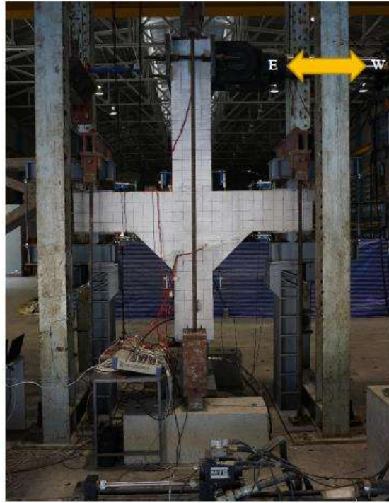
รูปที่ 3-27 รูปแบบการทดสอบและ Reaction Frame ที่จำลองแรงกระทำต่อรอยต่อคานเสาสะพาน
