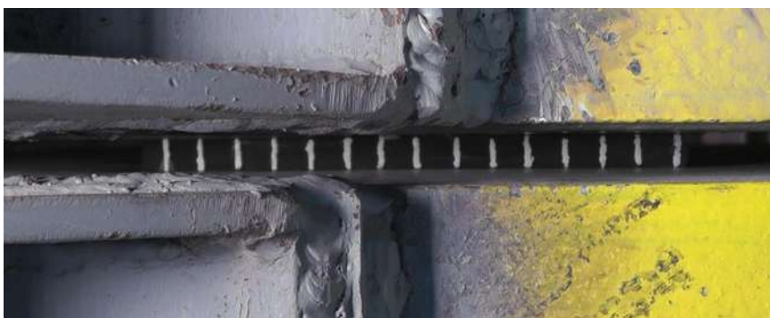
รูปที่ 2-63 แผ่นยางรองสะพานในขณะรับแรงกระทำเท่ากับ 175 % shear strain
