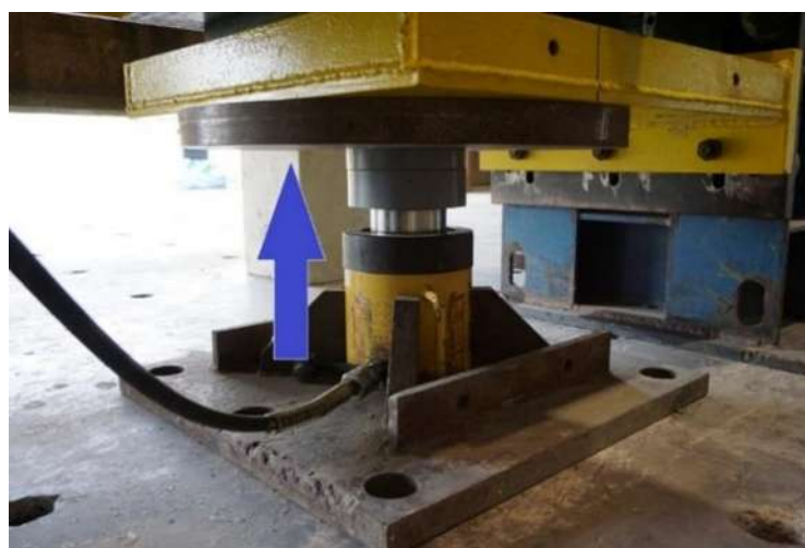
รูปที่ 4-5 การให้แรงอัดในแนวแกนด้วยแท่นไฮดรอลิก
