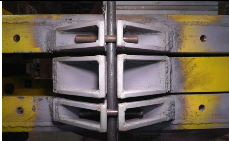
รูปที่ 2-69 เหล็กเดือยภายหลังการติดตั้งเข้ากับชุดทดสอบ
