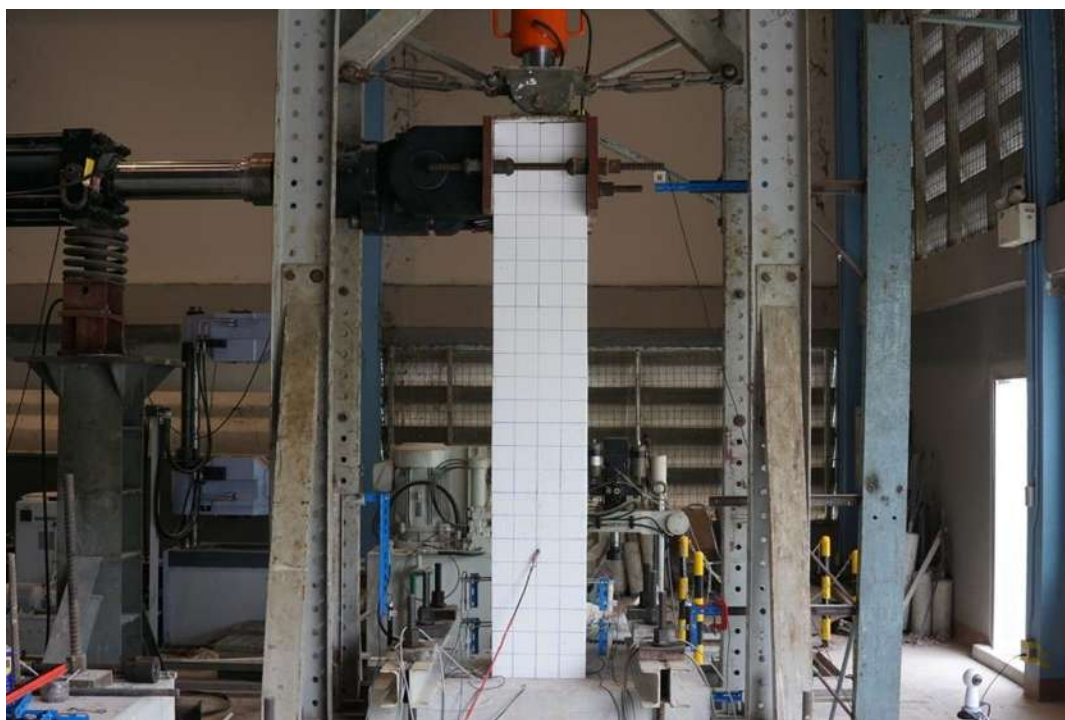
รูปที่ 4-29 ตัวอย่างการจัดวางอุปกรณ์สำหรับทดสอบเสา
