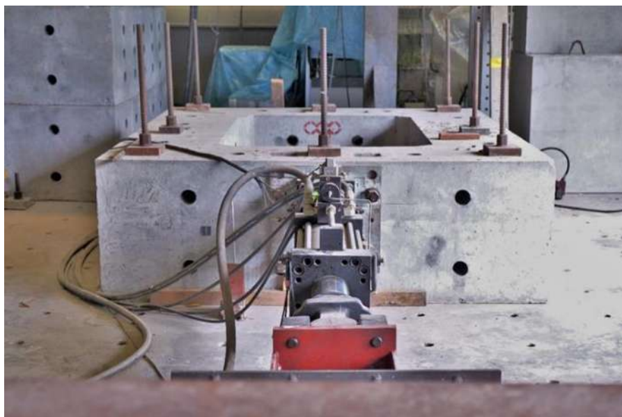
รูปที่ 4-1 ผนังรับแรงที่ยึดติดกับพื้นห้องปฏิบัติการด้วยเหล็กอัดแรง
