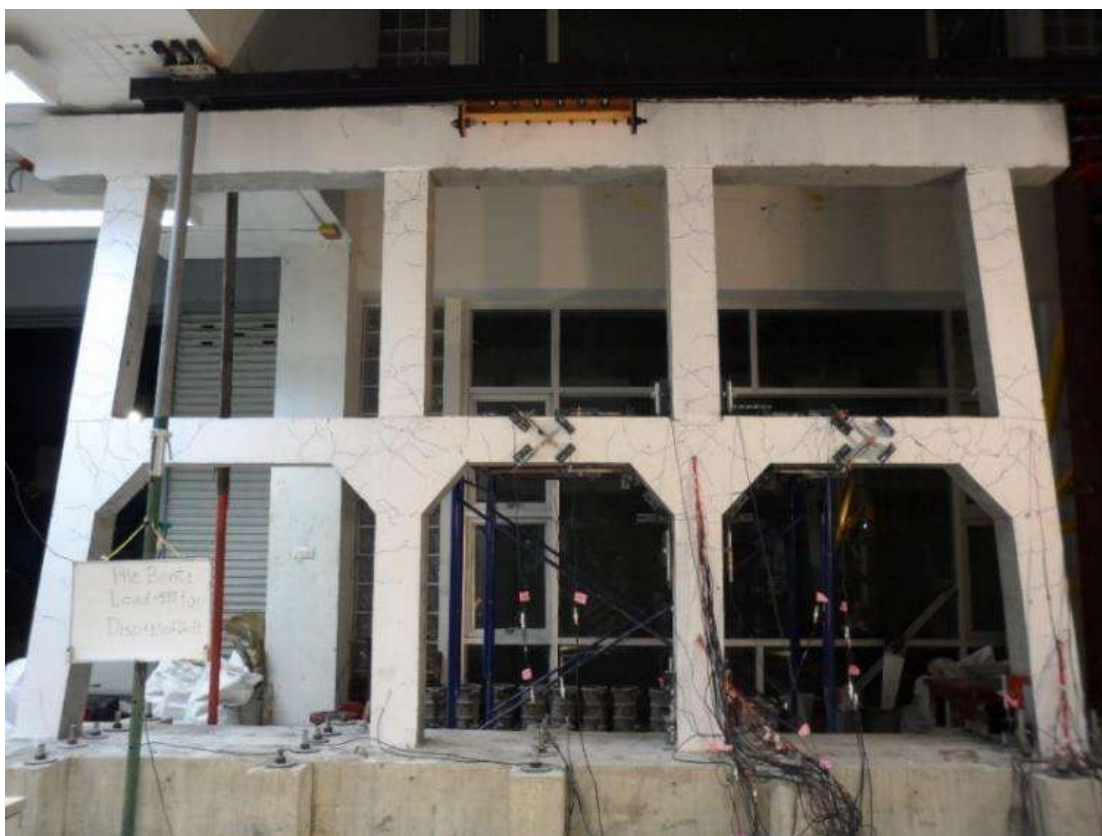
รูปที่ 5-4 รูปแบบความเสียหายของตอม่อสะพานช่วงสั้นตามแบบมาตรฐานกรมทางหลวงปี 1994
