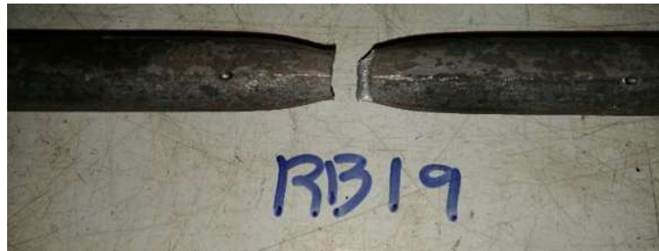
รูปที่ 2-83 ลักษณะการวิบัติเนื่องจากแรงดึงของเหล็กเดือย RB19
